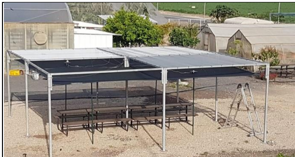
איור 3. המבנה שבאיור 2 לאחר התקנת מדי קרינת שמש ותוספת רשת שחורה 80% מתחת למדי קרינה למניעת החזרים מהקרקה.
