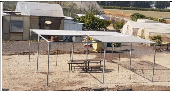
איור 2. מבנה למדידת תכונות קרינתיות של 3 רשתות באתר צמח נסיונות. המדידות יהוו מודל לשינויים בתכונות הרשתות לאורך העונה.
