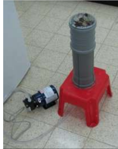
תמונה 1. מגדל לבחינת שחרור אסקוספורות שנבנה על ידנו.
