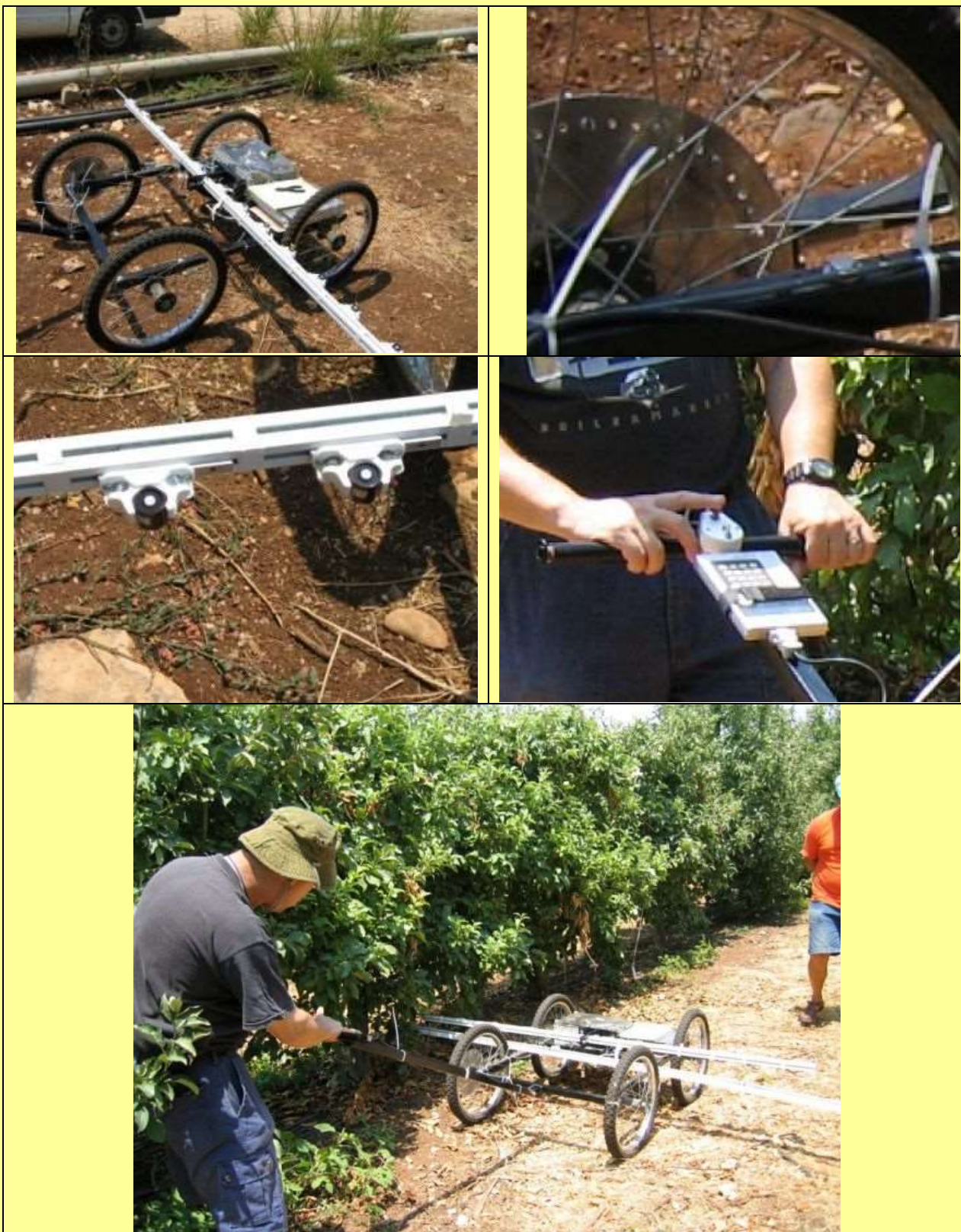
תמונה 1. תאור עגלת המפוי. משמאל ומלמעלה: מראה כללי, גלגל כוון מרווח דיגום, עיניות מד קרינה, ידית הבקרה. למטה: העגלה בפעולה, עם מוט אור ידני מקביל להשוואת הקריאות.
