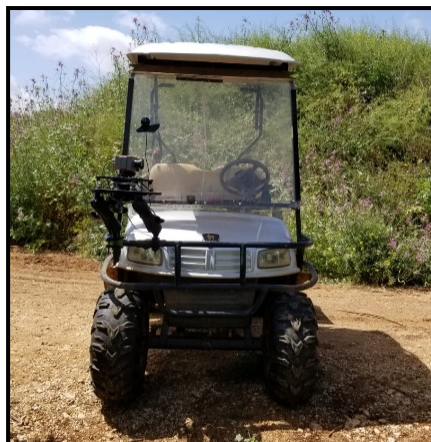
תמונה 3 - הרכב החשמלי איתו בוצע הניסוי ועליו המערכת של FruitSpec
