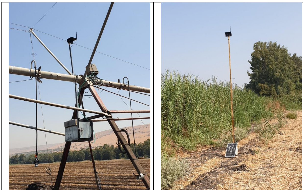
איור 3. מערכת RTK-GPS בדיוק סנטימטרים. תחנת בסיס (ימין) והתקן מעקב על הקונוע (שמאל).
