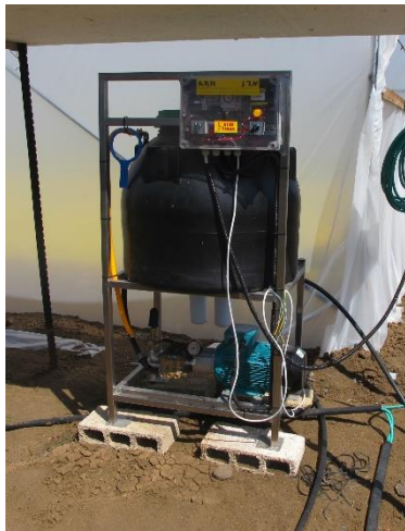
תמונה 4. רכיבים ממערכת צינון התנדפותי. ימין-פומית (דיזה) ערפול בלחץ גבוה, שמאל – מיכל מים, משאבה ולוח פיקוד
