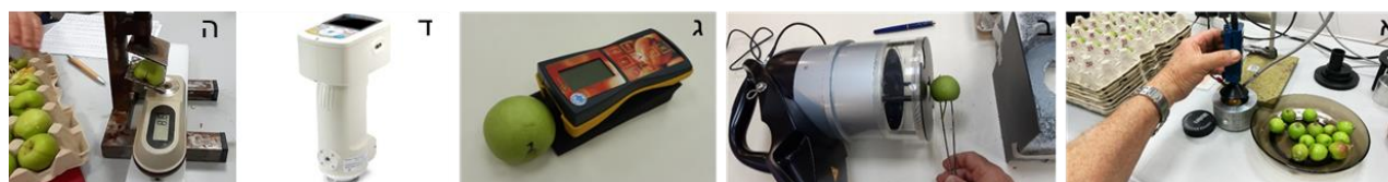
איור 2- [א] מדידת NIR בתפוחים; [ב] מדידת פלואורוסציה בתפוחים באמצעות Multiplex; [ג] מדידת DA באמצעות Dameter; [ד] מד צבע נייד MINOLTA ו-[ה] מדידת סוכר באמצעות רפראקטומטר דיגיטלי.
