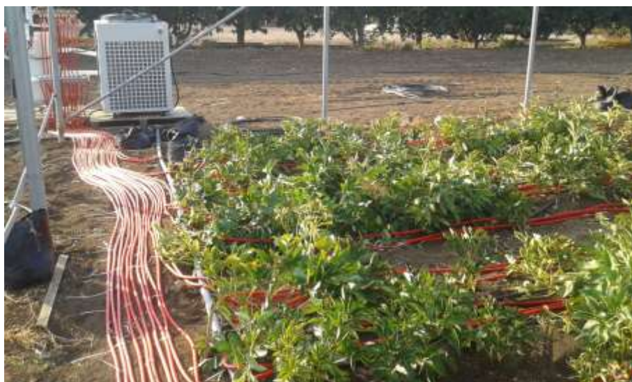
תמונה 1. מערכת לצינון/חימום הקרקע לפני הנחת הבידוד וכיסוי בקרקע. אבני איתן, אוגוסט 2016.
