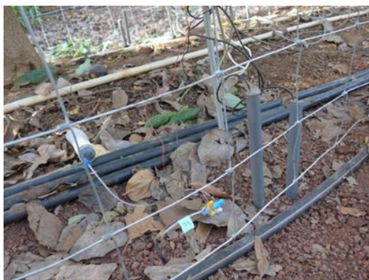
איור 4: אלקטרודות ודוגם תמיסה מוצבים בקרקע
